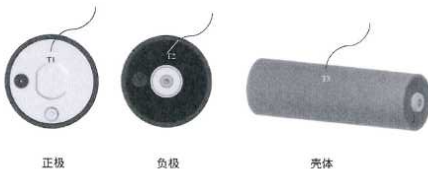
图2 电池温度采集点示意图 Cell temperature monitoring diagram
